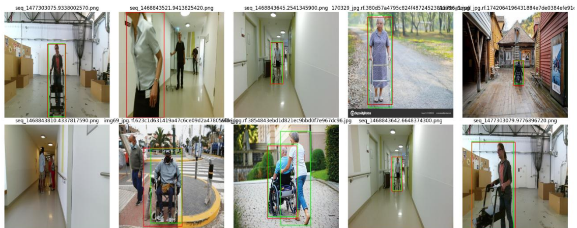
Ilustración 73. Ejemplos de imágenes redimensionadas a 600x600 píxeles evaluadas por el modelo de clasificación de objetos de movilidad reducida.
