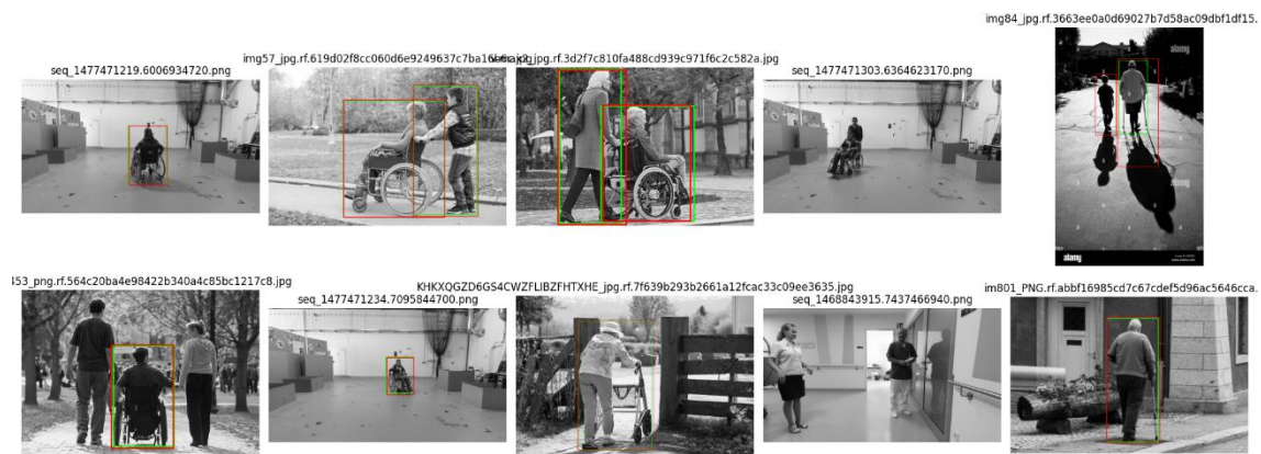
Ilustración 48. Ejemplos del conjunto de evaluación en escala de gris procesados por el modelo de red neuronal. En verde se muestran los ground truth, mientras que en rojo se muestran las regiones detectadas por el modelo.
