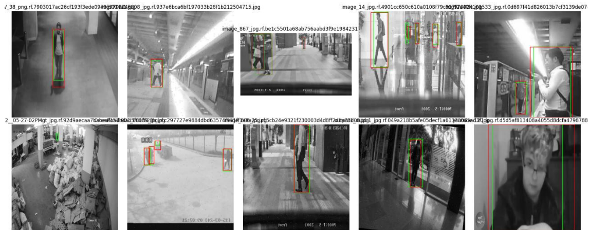
Ilustración 44. Ejemplos del conjunto de evaluación en escala de gris procesados por el modelo de red neuronal. En verde se muestran los ground truth, mientras que en rojo se muestran las regiones detectadas por el modelo.
