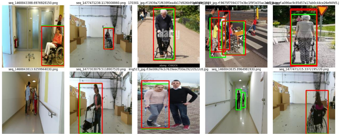
Ilustración 67. Ejemplos de imágenes redimensionadas a 200x200 píxeles evaluadas por el modelo de clasificación de objetos de movilidad reducida.
