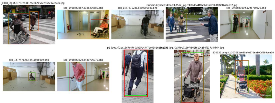
Ilustración 41. Ejemplos del conjunto de evaluación procesados por el modelo de red neuronal. En verde se muestran los ground truth, mientras que en rojo se muestran las regiones detectadas por el modelo.
