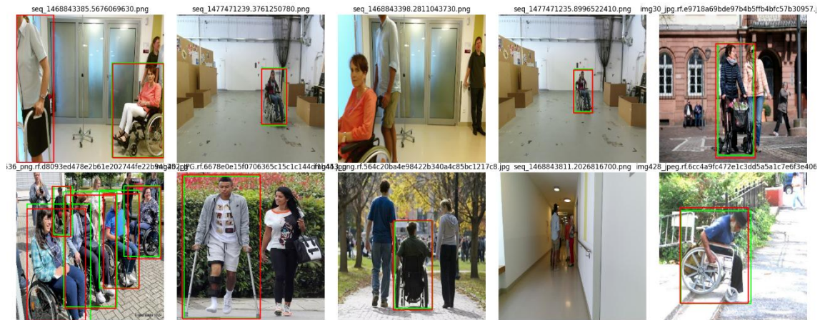
Ilustración 70. Ejemplos de imágenes redimensionadas a 400x400 píxeles evaluadas por el modelo de clasificación de objetos de movilidad reducida.
